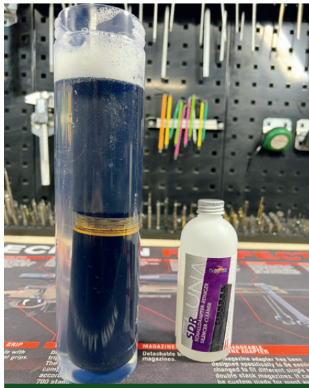
Verschmutzter Schalldämpfer in der Reinigungslösung
