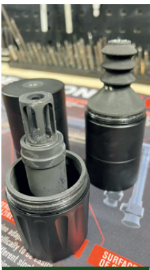
Zerlegtes, 3-teiliges Schalldämpfermodular vor der Reinigung mit Ultraschall
